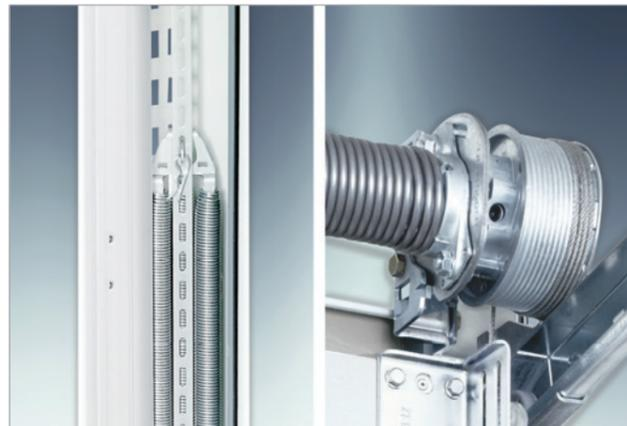
Unsere Premium-Sektionaltore EVOLUTION ISO 45 erhalten Sie wahlweise mit vertikalem Zugfedersystem oder mit stabilen Torsionsfederwellen mit wartungsfreier, nach DIN EN 12604 geprüfter Federbruch-Sicherung.
