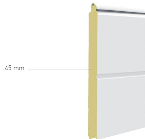
Premium-Sektionaltor EVOLUTION ISO 45 ist mit einem 45 mm-Hartschaumkern gefüllt, der für sehr hohe Wärmedämmung und hohe Schallschutzwerte sorgt.
