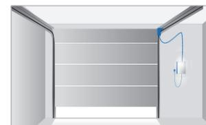
Antrieb in der rechten Torlaufschiene. Steuerung direkt neben dem Tor im Bereich des Seitenanschlags.
