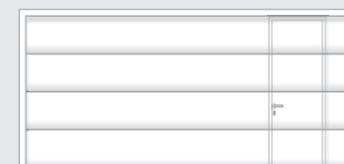
Asymmetrische Anordnung bei Torbreite bei BRB 3.501 - 5.000 mm – aus der Mitte links oder rechts
