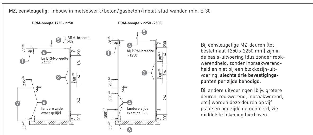
EI<sub>2</sub>30, MZ, E-S\*: Inbouw in metal-stud-wanden min. EI 30 RC
