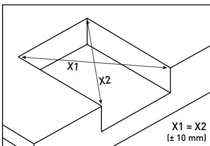
Consejo: A lo ancho el puente de sobrecarga deberá montarse totalmente horizontal. Por otro lado la funcionalidad del puente de sobrecarga puede verse limitada. De igual manera existe el peligro de daños en el puente de sobrecarga.
