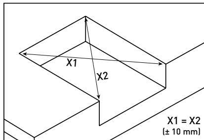
Hinweis: In der Breite muss die Überladebrücke exakt waagerecht eingebaut werden. Andernfalls kann die Funktionsfähigkeit der Überladebrücke eingeschränkt sein. Ebenso besteht die Gefahr einer Beschädigung der Überladebrücke.
