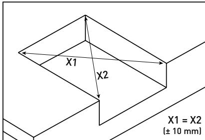
Instructie: De leveller moet in de breedte exact horizontaal worden ingebouwd. Anders kan de functionaliteit van de leveller worden ingeperkt. Bovendien kan de leveller beschadigd raken.
