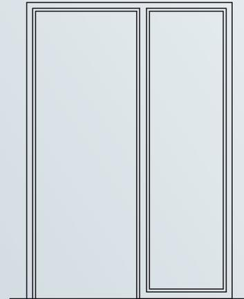
Stahlzarge mit feststehendem Seitenteil.
